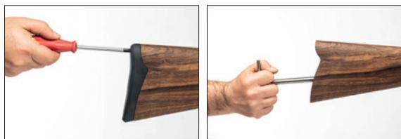
**Sentetik kundak için;** Dipçiği tüfekten ayırmak için önce omuzluk pedini altında bulunan pime basarak çıkartın. Daha sonra 5'lik alyan yardım ile içerisinde bulunan cıvatayı saat yönünün tersi yönde çevirerek sökün ve dipçiği gövdeden ayırın.
