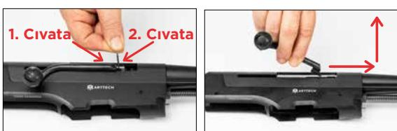
5. Mekanizmayı çıkarmak için önce sürgüyü sürgü kollarından düz bir tonavida ile ayırın. Daha sonra mekanizma grubunu geriye doğru çekerek üst gövdenin çıkartın.
