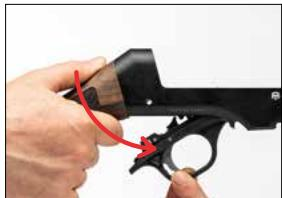
**8 Для деревянного приклада:** Чтобы снять деревянный приклад, открутите винт затыльника и потяните затыльник назад. Сняв затыльник, открутите винт крепления приклада с помощью специального инструмента (шестигранный ключ на 5 мм) и разъедините их.
