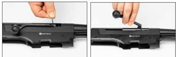
5. Чтобы снять кожух затвора, отделите раму от тяги с помощью отвертки с прямым шлицем. После этого возьмитесь за кожух и потяните его до упора назад.
