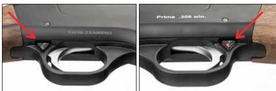
**REMARQUE :** Le bouton pousoir de sécurité est situé à l'arrière du pontet. Il doit être en position "SECURITE" en tout temps, sauf avant le tir.
