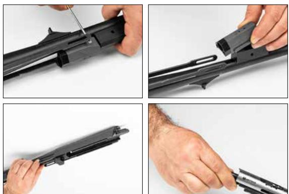
6. Pour retirer le canon de la partie supérieure du boîtier, dévissez la vis d'assemblage du canon avec une clé de 12 mm et séparez-les.
