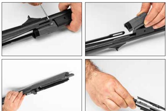
6. Чтобы снять ствол с верхней части ствольной коробки и, ключом на 12мм открутите винт крепления ствола и разъедините их.
