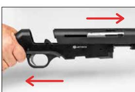
4. Üst grupta bulunan mekanizma kurma kolunu yarıya kadar çekin ve koruma sacını ileri doğru itin. Mekanizma kurma kolunda bulunan 2 adet civatayı saat yönünün tersine çevirerek çıkarın ve kurma kolunu ileri doğru iterek mekanizmadan ayıran.
