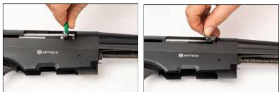
5. Pour retirer le chariot de culasse, séparez la glissière des tringles à l'aide d'un tournevis plat. Ensuite, tirez-le au maximum vers l'arrière.
