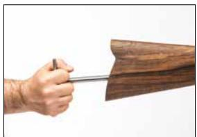
**Sentetik kundak için;** Dipçiği tüfekten ayırmak için önce omuzluk pedini altında bulunan pime basarak çıkartın. Daha sonra 5'lik alyan yardım ile içerisinde bulunan civatayı saat yönünün tersi yönde çevirerek sökün ve dipçiği gövdeden ayıran.
