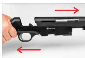
4. Оттяните рукоятку затвора наполовину назад. Открутите винт рукоятки затвора специальным ключом и снимите его с затвора.
