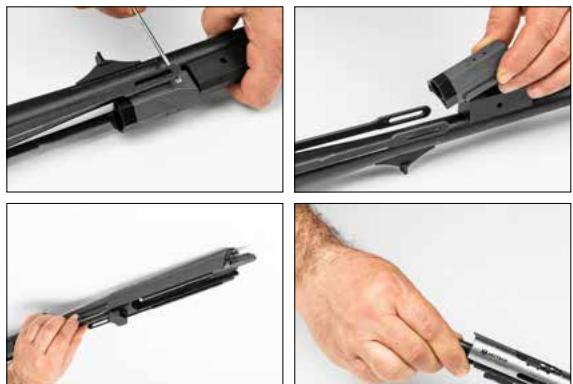
6. Üst gövdeyle namluyu ayırmak için 12'lik anahtar kullanarak namlı bağlantı civatasını saat yönünün tersi yönde çevirerek sökün ve namlıyla üst gövdeyi birbirinden ayıran.
